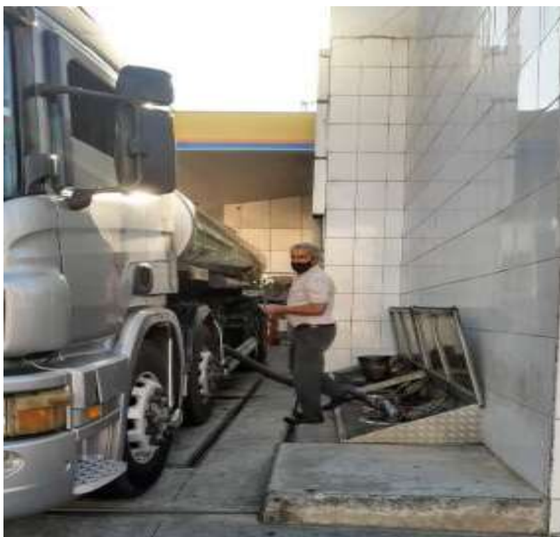
Processo de descarga de combustível.
